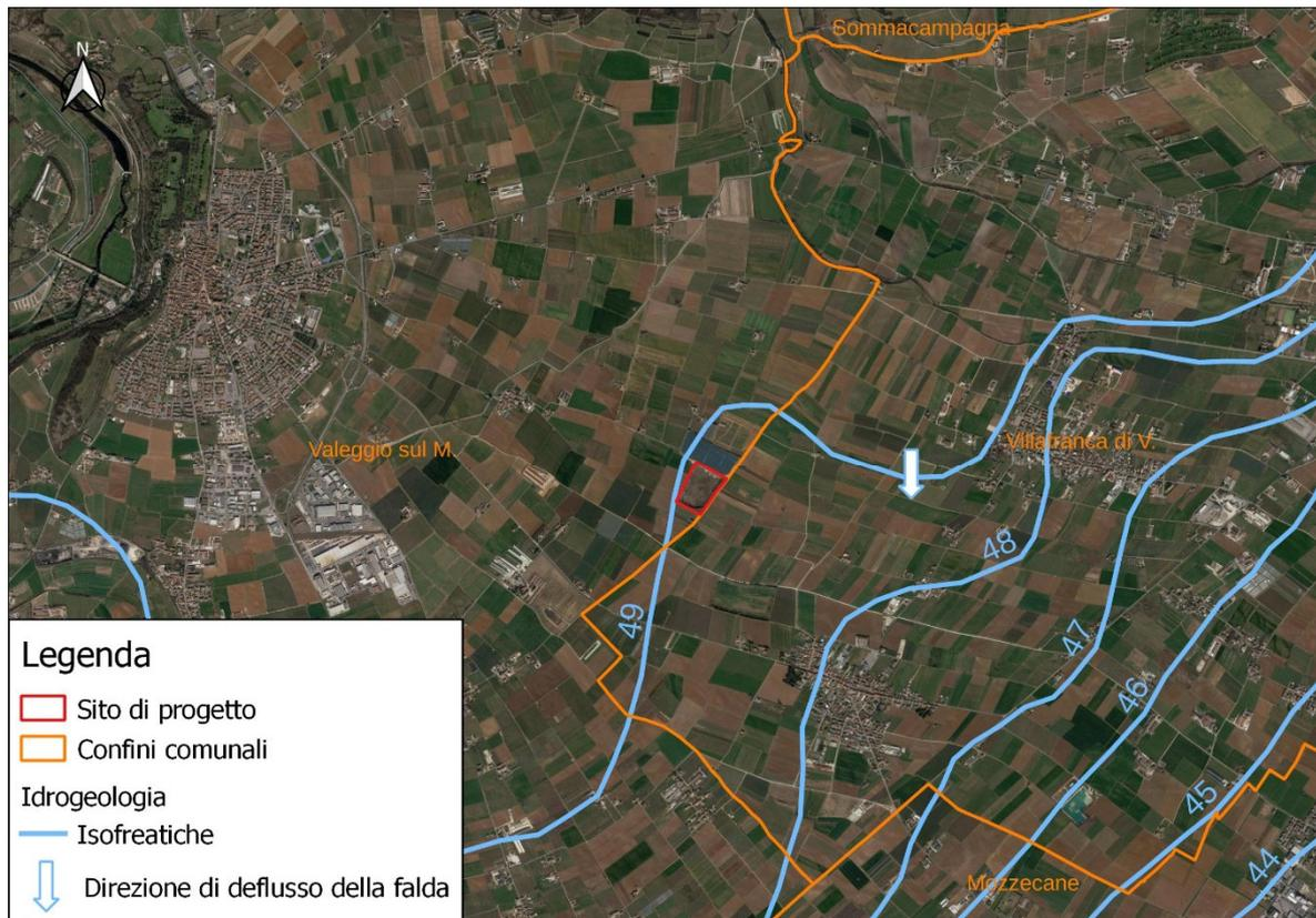
Figura 10 Idrogeologia dell'area di progetto (Fonte: PTCP della provincia di Verona; Elaborazione TERRA SRL)
